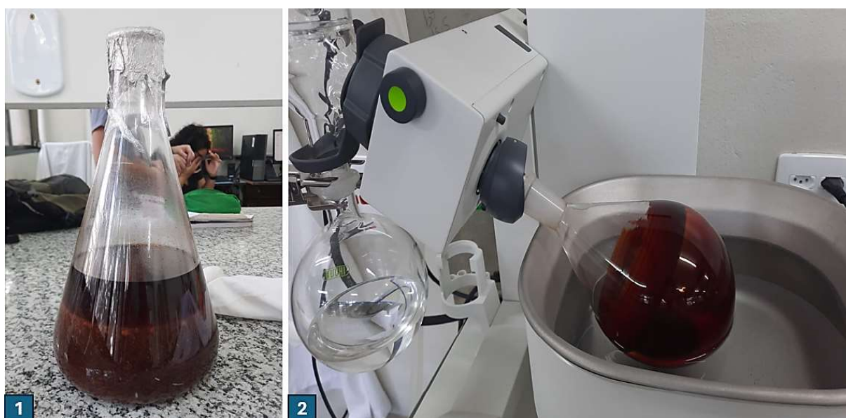
Figura 1. Processo de extração alcoólica do material vegetal, evidenciando a maceração da amostra em etanol dentro de um frasco Erlenmeyer. Figura 2. Etapa de evaporação do solvente por rotaevaporação, concentrando o extrato bruto obtido após a extração alcoólica.
