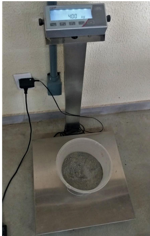
Figura 2: Demonstração da pesagem dos componentes do concreto.
