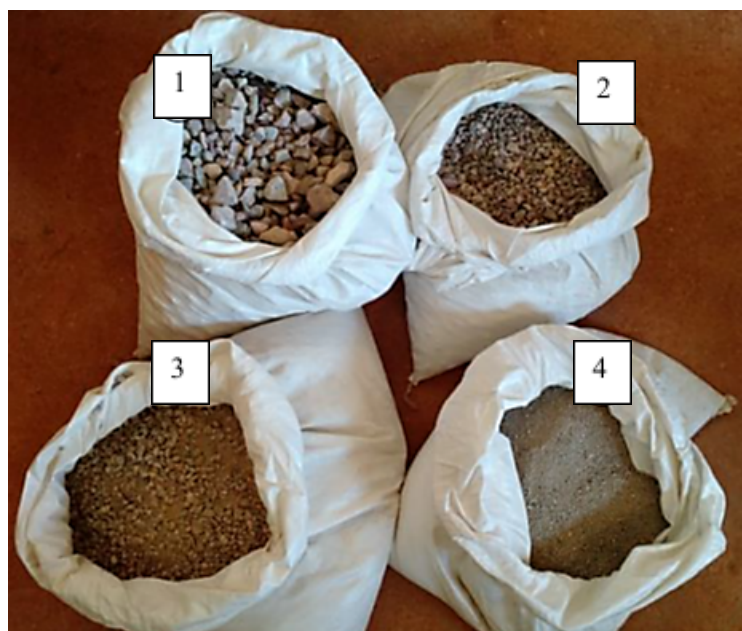
Figura 09: Material coletado – RCD.
