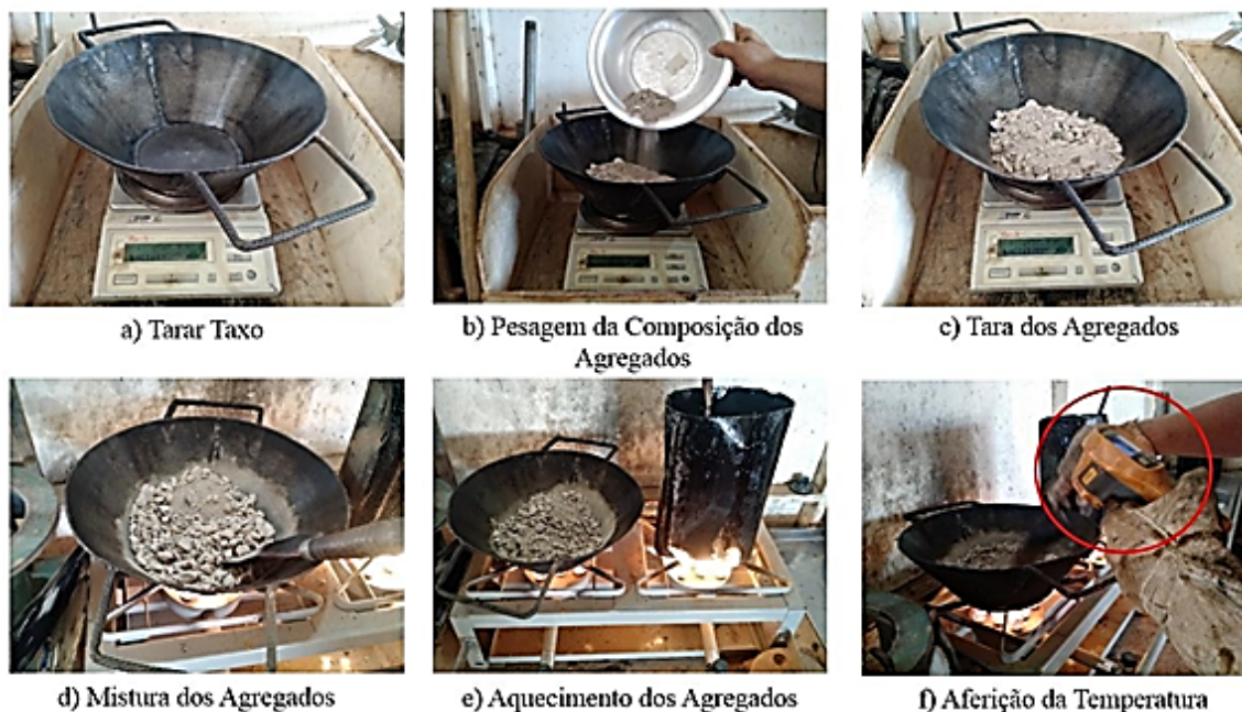
Figura 17: Aquecimento do agregado.
