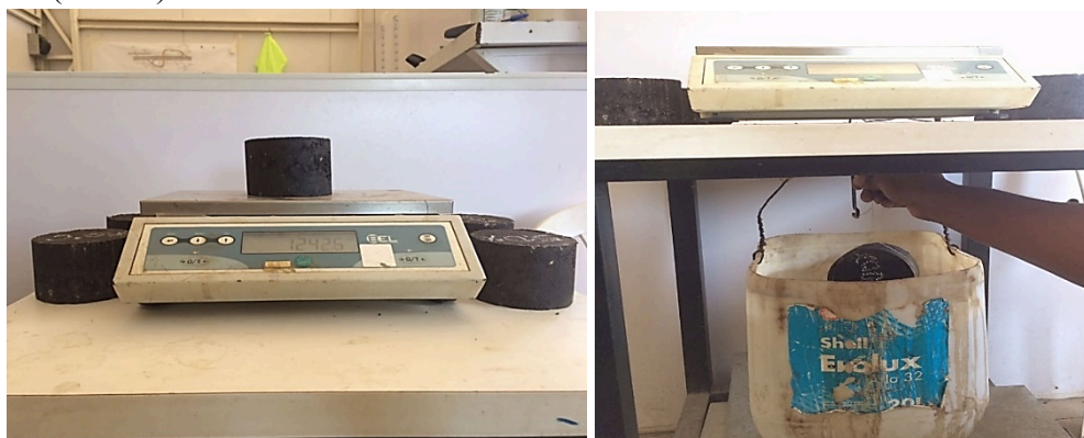
Figura 22: Determinação da Massa Seca ( M_s ) e Determinação da Massa Submersa ( M_{sub} ).
