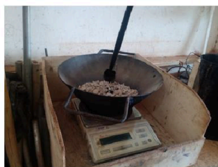
a) Tara da Balança com Taxo e Agregado
