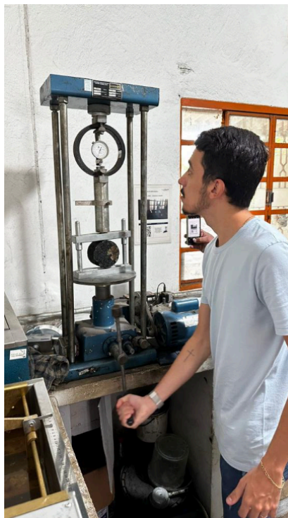
Figura 25: Ensaio de compressão diametral.
