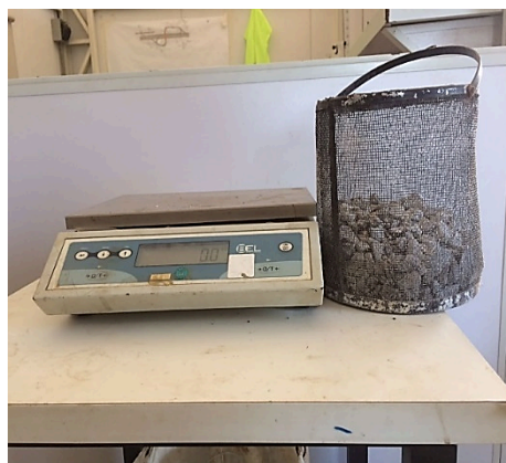
Figura 16: Ensaios de densidade para agregados graúdos e miúdos.
