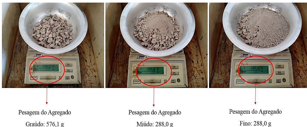
Figura 14: Determinação do teor de agregados para moldagem do CP.
