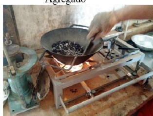
d) Mistura dos Agregados e CAP
