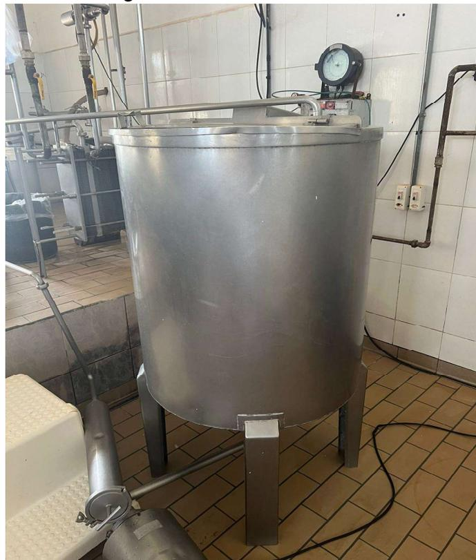
Pasteurizador de leite, método de pasteurização é o lento que consiste no aquecimento do leite entre 62°C e 65°C.
