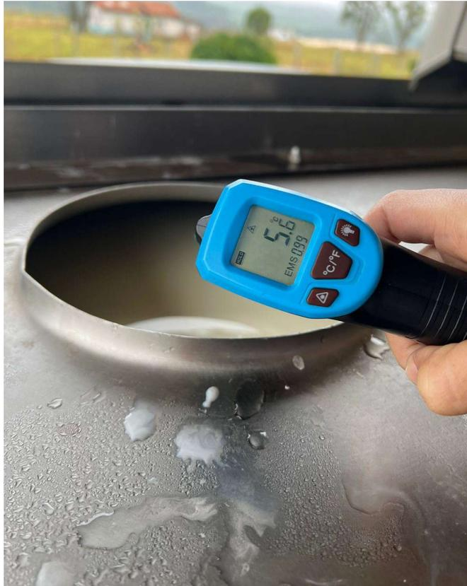
Controle da temperatura realizado no tanque de resfriamento do leite.
