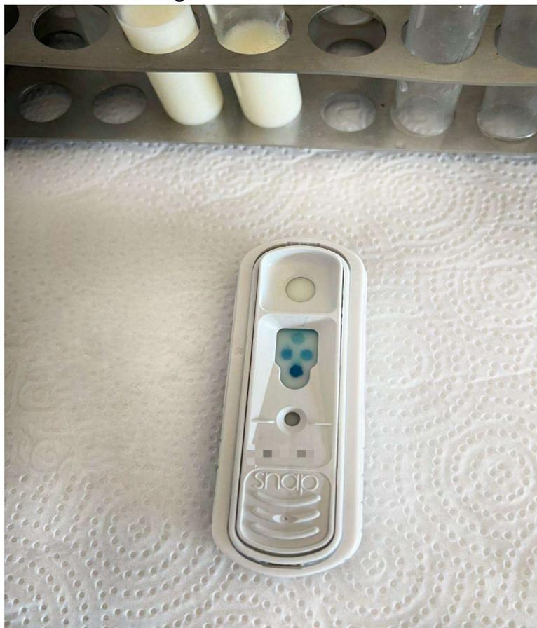
Interpretação do teste: Círculo do lado direito: Ponto de controle, círculo superior: identificação de Tetraciclina, círculo esquerdo: identificação de beta-lactâmicos, e círculo inferior: identificação de cefalexina.
