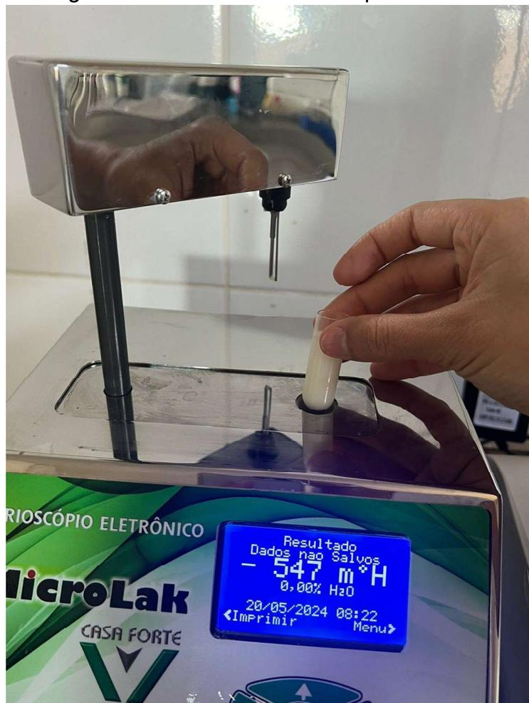
Crioscópio eletrônico identifica adulteração do leite causada por adição de água.
